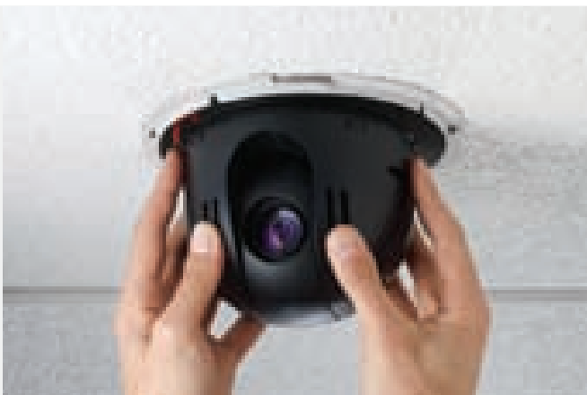
Mettez en place le nouveau module « remplaçable à chaud » ici une caméra mobile...
