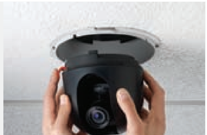
Enlevez le module « remplaçable à chaud » ici une caméra fixe...
