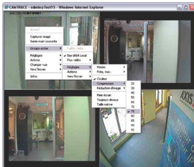
Réglage du niveau de compression d'un groupe faible débit. Le flux vidéo du groupe est compressé pour l'opérateur tandis que l'enregistrement conserve la qualité native.
