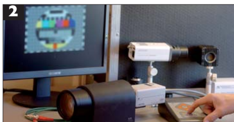
2 - Exécuter un léger zoom arrière. En règle générale, vous constatez un flou à l'image : réglez, alors, le focus arrière de la caméra (back focus, tirage optique).
